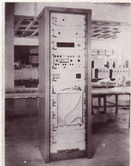
Bild 7 Steuerung, Bedienungspult und numerische Anzeige in einem Schrankgestell
