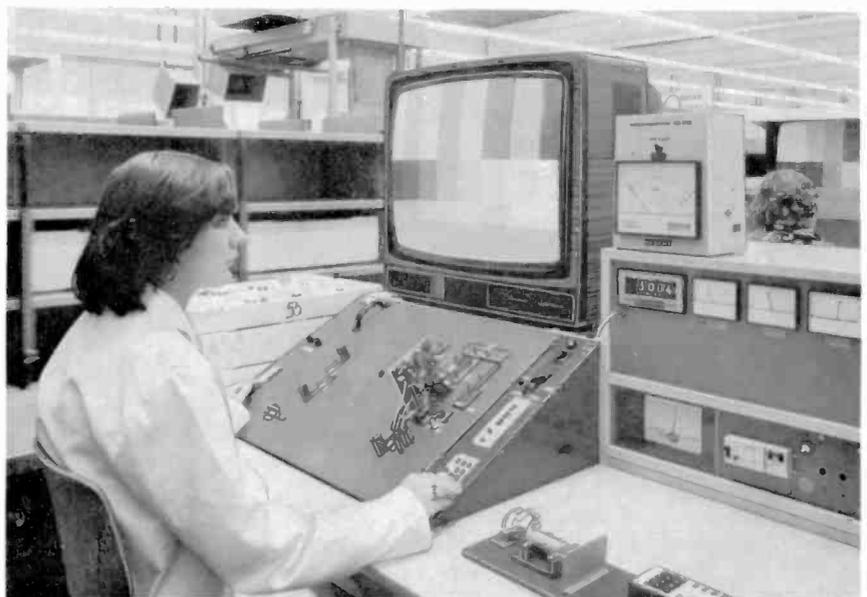
Bild 6 Prüfplatz der Endkontrolle
