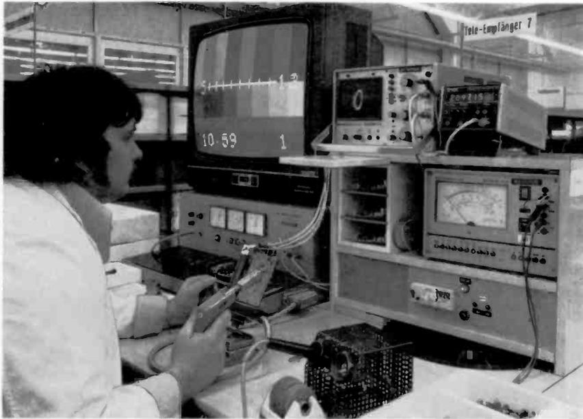
Bild 3 Reparaturplatz Uhrbaustein (Helzeinschub in Bildmitte)
