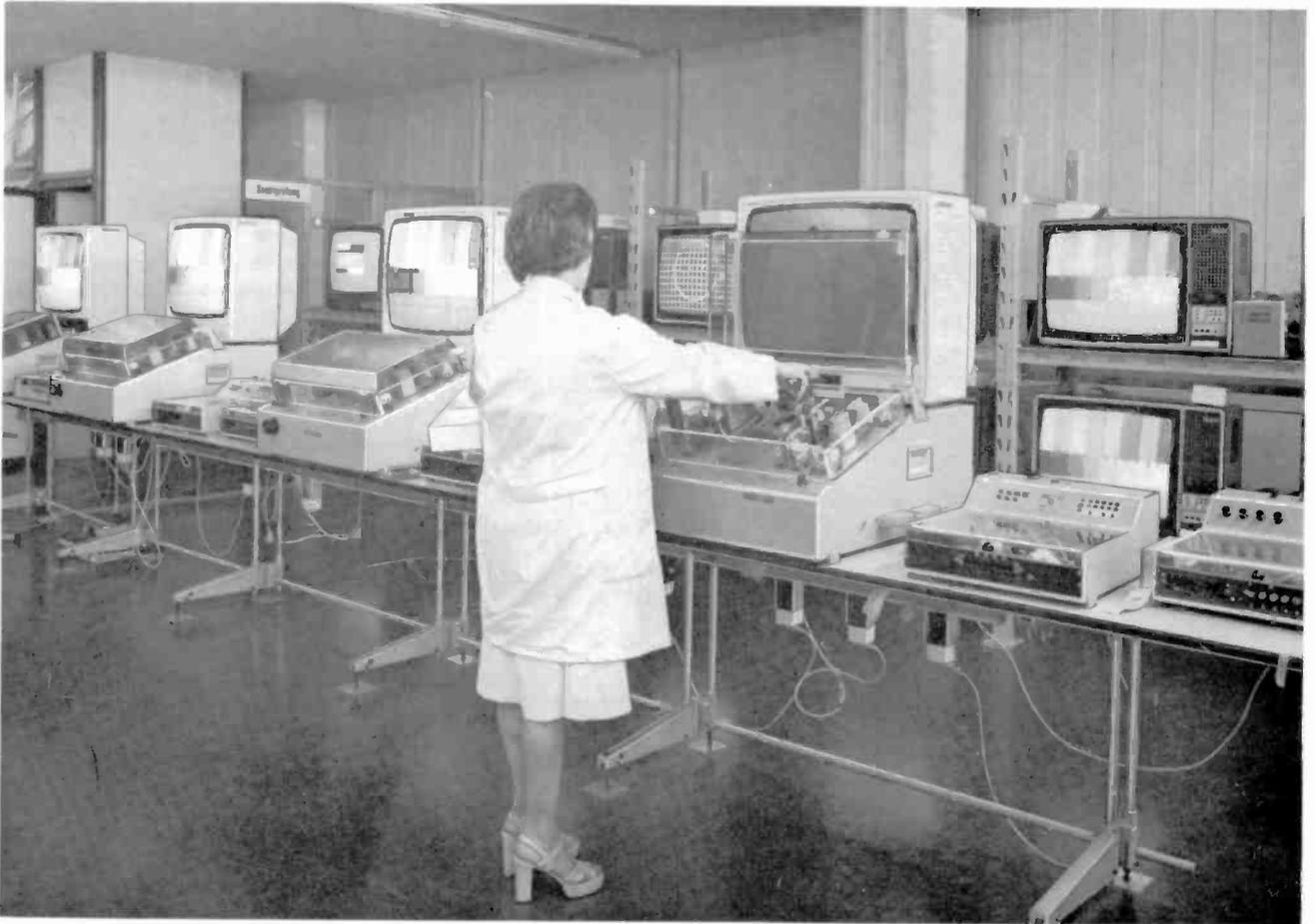
Bild 5 Dauerprüfanlage für Module mit Langzeitfehlern
