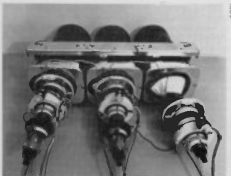
Bild 11 Blick auf die Rückseite des Projektionsgerätes. Das zurückgezogene Joch der rechten Röhre läßt den Abschirm tragen mit Bleifolie erkennen.
