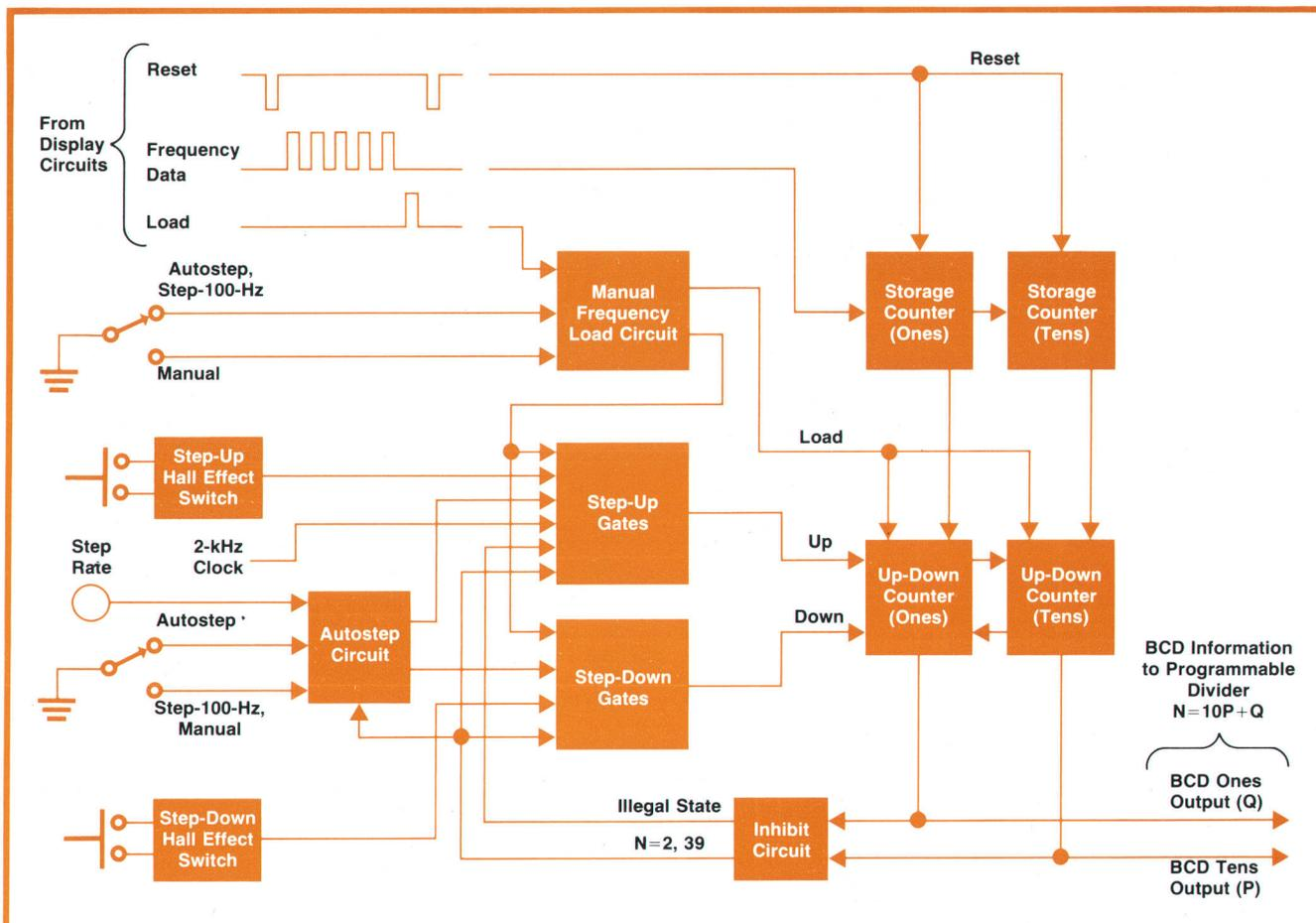
Fig. 3. Step-100-Hz circuit
