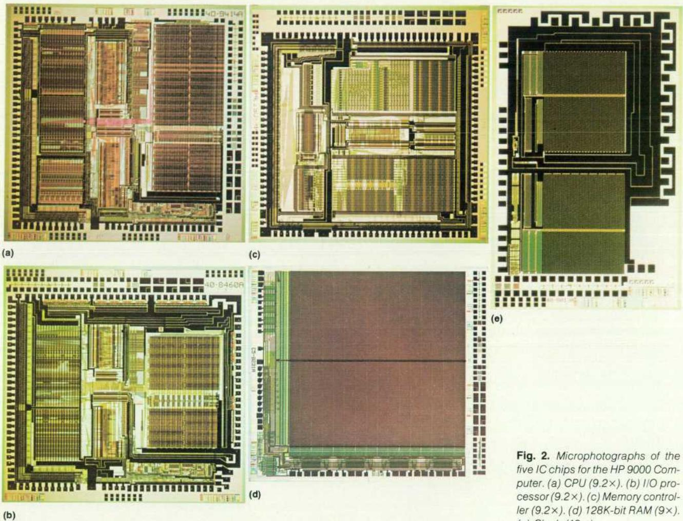
**Fig. 2.** Microphotographs of the five IC chips for the HP 9000 Computer. (a) CPU (9.2 $\times$ ). (b) I/O processor (9.2 $\times$ ). (c) Memory controller (9.2 $\times$ ). (d) 128K-bit RAM (9 $\times$ ). (e) Clock (13 $\times$ ).
