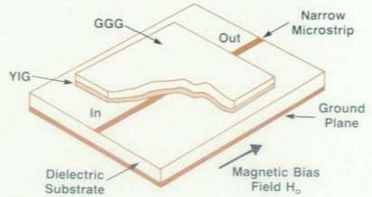
Fig. 14. Basic structure of an MSW signal-to-noise enhancer (Adam, et al<sup>10</sup>).
