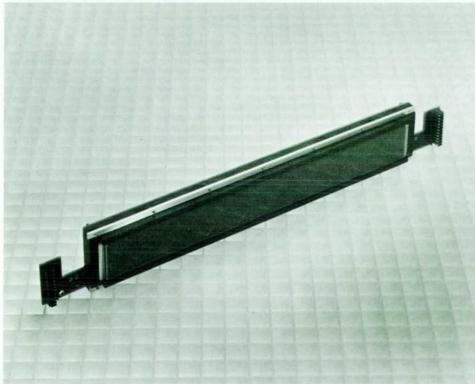
**Fig. 6.** LCD module.
