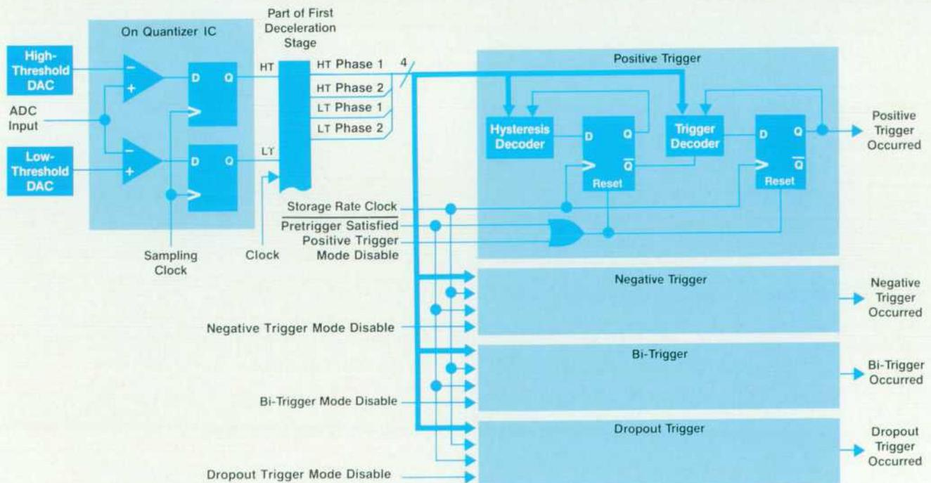
Fig. 7. Analog-digital trigger circuit.
