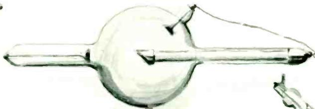
HEAVY COPPER ANODE X-RAY TUBE
