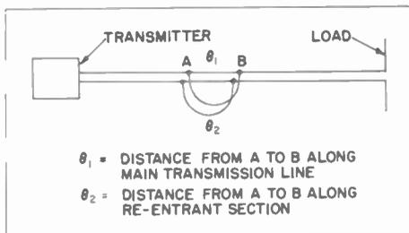
Figure 16. Simple Re-Entrant Network
