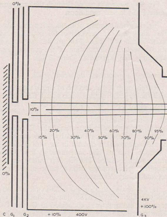
Fig. 6—Equipotentials in  $G_2$ - $G_3$  space, cathode test voltages.
