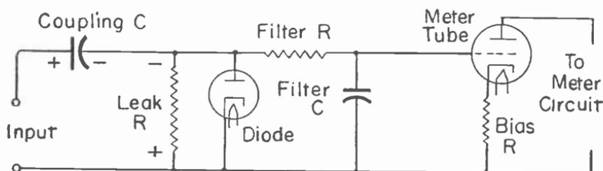
Fig. 12.—A diode rectifier for a voltmeter circuit.
