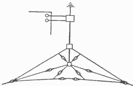
Fig. 22-19.—Web type antenna.
