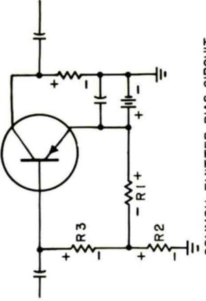
COMMON-EMITTER BIAS CIRCUIT FOR "NEGATIVE GROUND" SUPPLY
