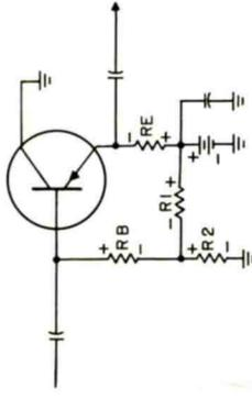
COMMON-COLLECTOR BIAS CIRCUIT FOR "NEGATIVE GROUND" SUPPLY
