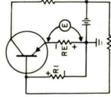
TEMPERATURE STABILIZATION OF DC OPERATION BY UTILIZING EMITTER RESISTOR
