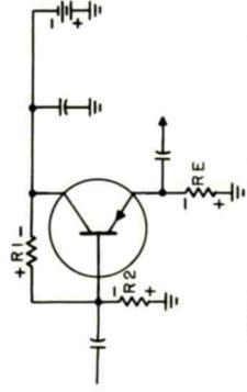
COMMON-COLLECTOR BIAS CIRCUIT FOR "POSITIVE GROUND" SUPPLY
