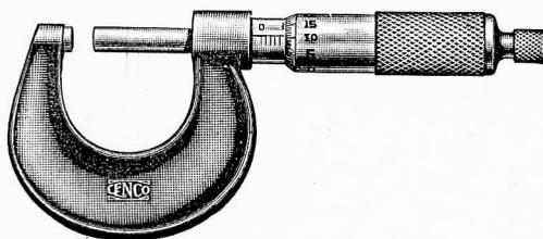
Fig. 14—A micrometer.
