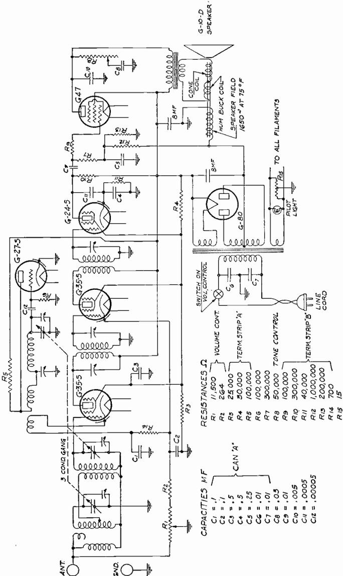
**SCHEMATIC DIAGRAM OF MAJESTIC SCREEN GRID SUPERHETERODYNE AUTOMATIC VOLUME CONTROL RECEIVER. MODEL 210 CHASSIS.**
