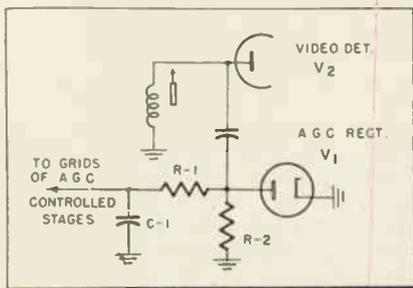
Fig. 4—Simple TV AGC circuit.
