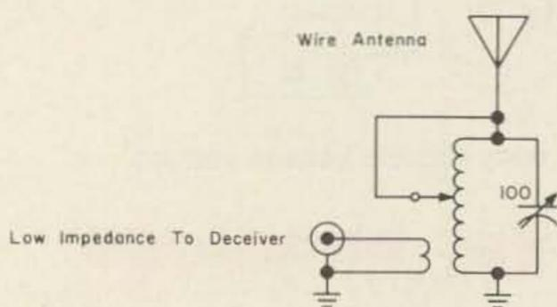
ANTENNA TUNER FOR RECEIVER DECEIVER
