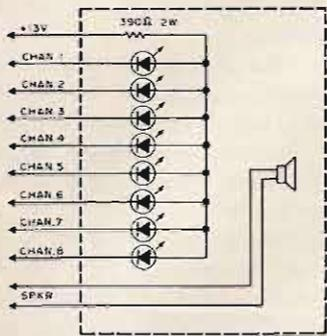
Fig. 3. All LEDs MV5026.
