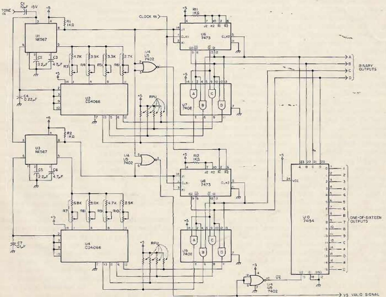
Fig. 1. Decoder circuit.
