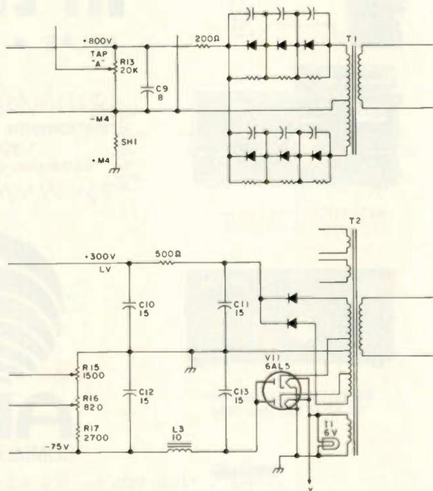
Fig. 2. Modified diagram. Diodes—1N4006s. R—1 meg. C—.01  $\mu$ F.
