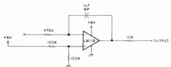
Fig. 3. Op-amp integrator using LM118.
