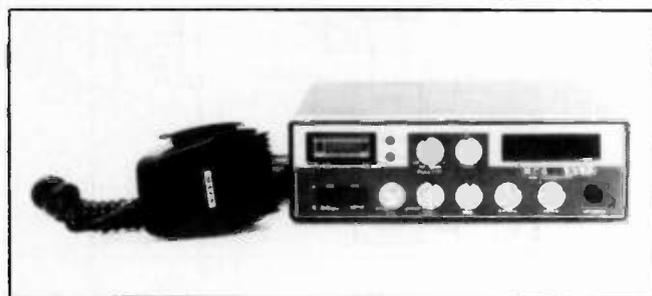
THE QRP RIG WITH THE **BIG RIG** SOUND ACTIVE NOISE BLANKER—RF GAIN—CW SWITCH—SQUELCH—MIC GAIN—DIGITAL FREQUENCY DISPLAY—HI/LO POWER SWITCH—13.8 VDC 5A POSITIVE OR NEGATIVE GROUND. 9.5" x 8.5" x 2.5"
