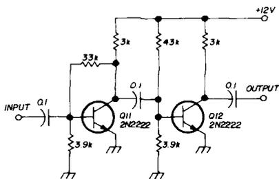
fig. 17. Alternate agc circuit.
