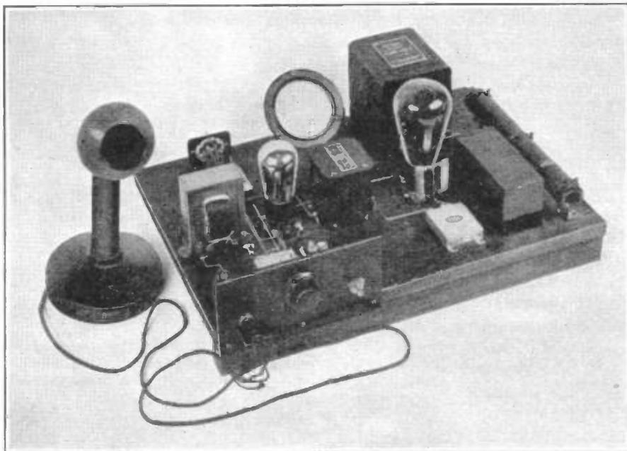
A SUITABLE SPEECH AMPLIFIER AND MODULATOR FOR THE LOW-POWER 'PHONE
