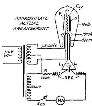
FIG. 1 THE ULTRAUDION CIRCUIT USED, SHOWING SCHEMATIC AND ACTUAL FORMS
