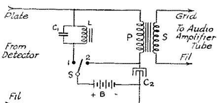
**FIG. 7. TUNED REJECTOR OR AUDIO FILTER TO MAKE AN AMPLIFIER EITHER PEAKED OR FLAT AT WILL**
