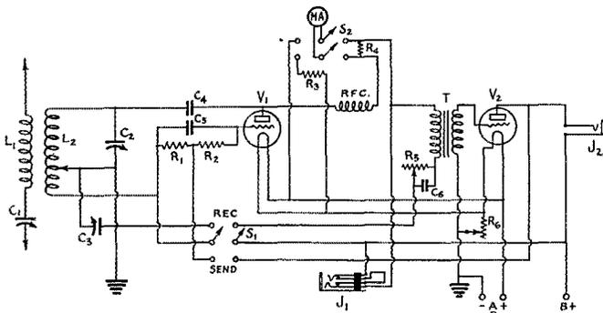
FIG. 1 — THE TRANSCIEVER CIRCUIT
