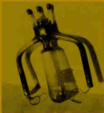
Fig. 3 A Cooper Hewitt mercury-arc rectifier tube.
