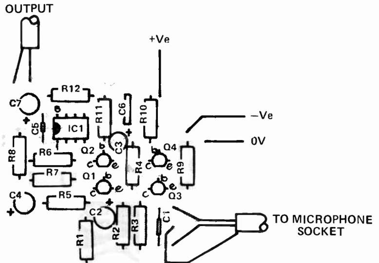
Fig. 3. Component overlay
