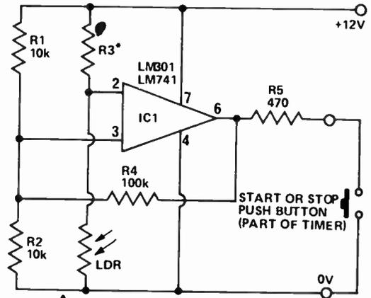
\*R3 SHOULD EQUAL LDR RESISTANCE AT OPERATING POINT (COULD BE VARIABLE)
