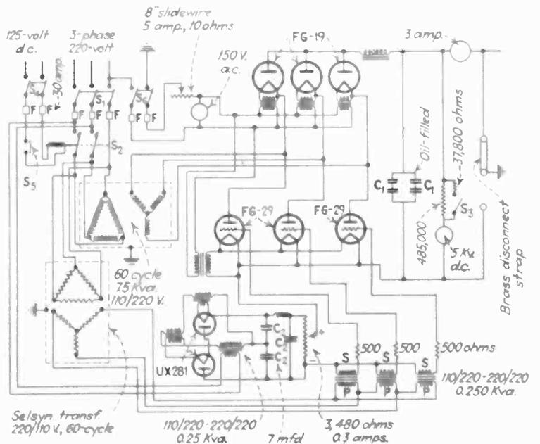
Fig. 4—Diagram of 7.5 kva., 5000-volt rectifier
