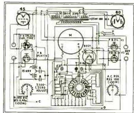
Fig. 2—Tester vtmv unit
