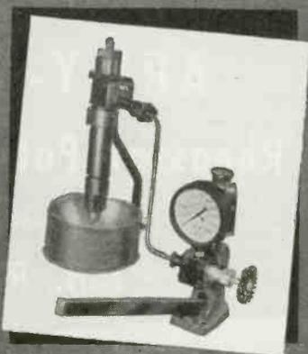
**TESTS FUEL INJECTORS
