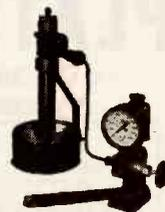
TESTS FUEL INJECTORS
