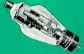
**17 GRID CONTROLLED MERCURY VAPOR RECTIFIER**
