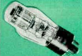
**884 GRID CONTROLLED ARGON RECTIFIER AND OSCILLATOR**
