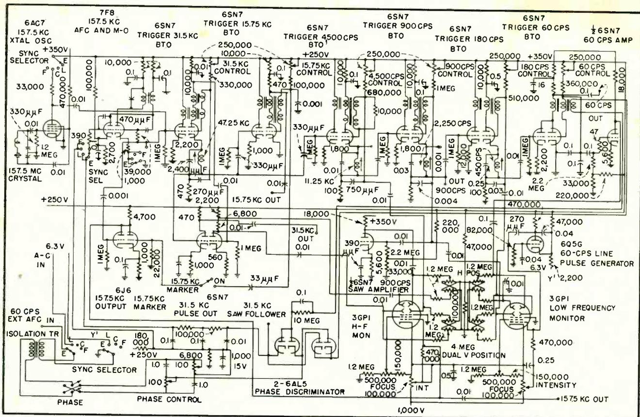
FIG. 2—Timing generator circuits of the Du Mont TA107 A/B sync generator
