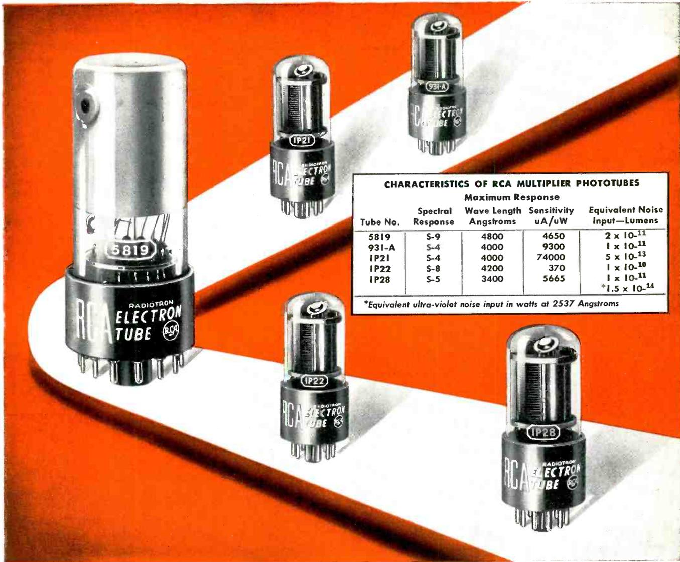
**CHARACTERISTICS OF RCA MULTIPLIER PHOTOTUBES**
