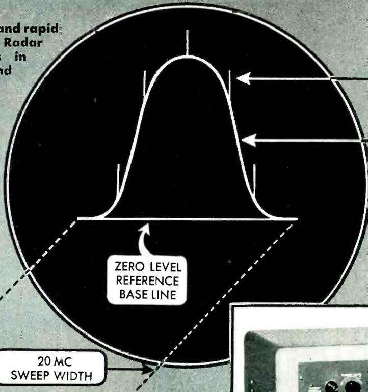
CRYSTAL-POSITIONED PULSE TYPE FREQUENCY MARKS
