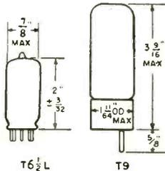
Maximum Wattage Dissipation: T6 $\frac{1}{2}$ L—5W. T9—10W.
