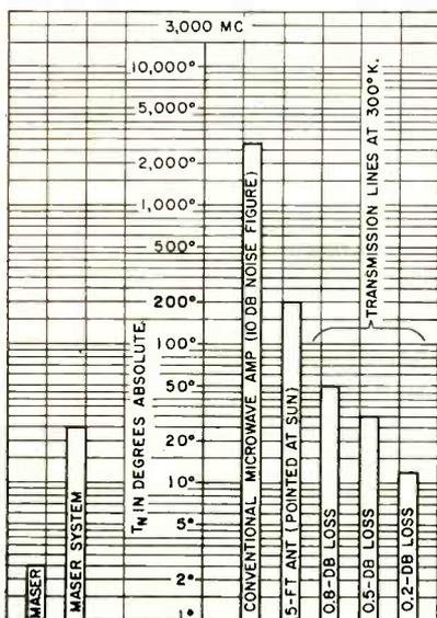
FIG. 15—Noise-temperature scale. Noise power =  $kT_n B$
