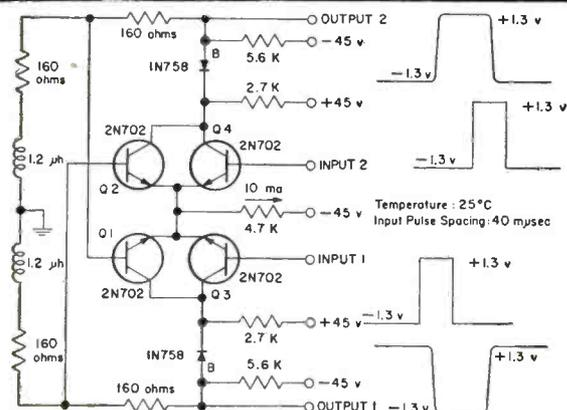
TYPICAL CIRCUITRY FOR OBTAINING 25-MC REP RATE
