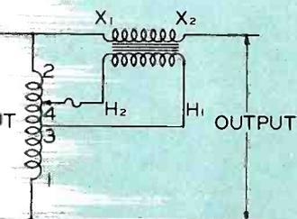
TYPICAL MANUALLY OPERATED SINGLE PHASE LINE CORRECTOR POWERSTAT TYPE LC CONNECTION 6
