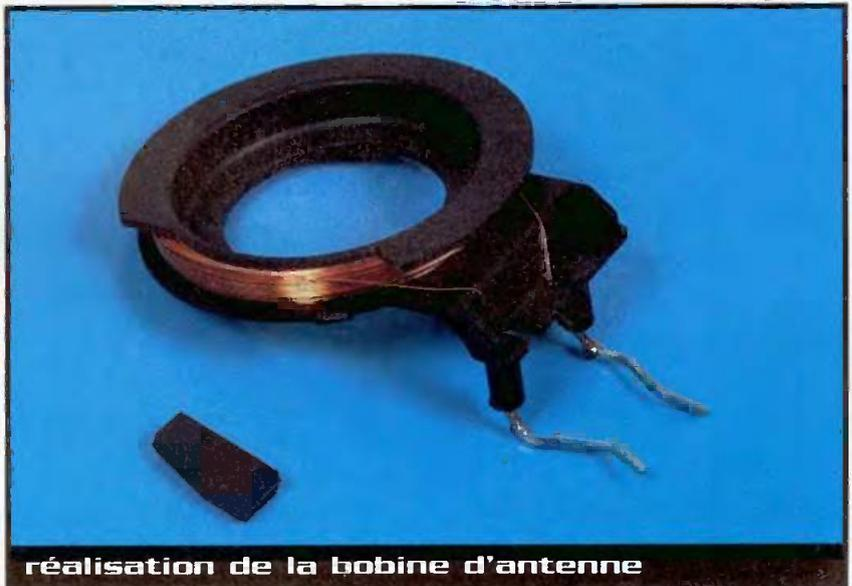
**réalisation de la bobine d'antenne**
