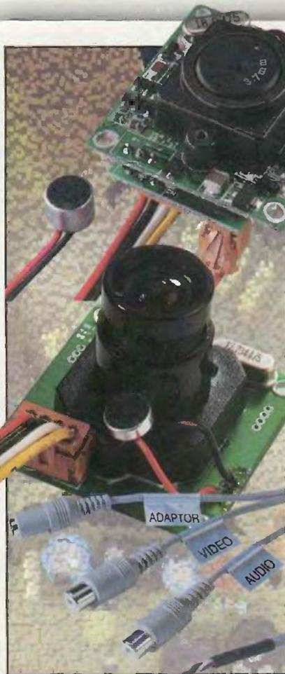
Un autre module, en technologie CCD noir et blanc, le modèle TVCCD-30MA, est quant à lui, équipé d'un amplificateur audio et d'une capsule microphone.
