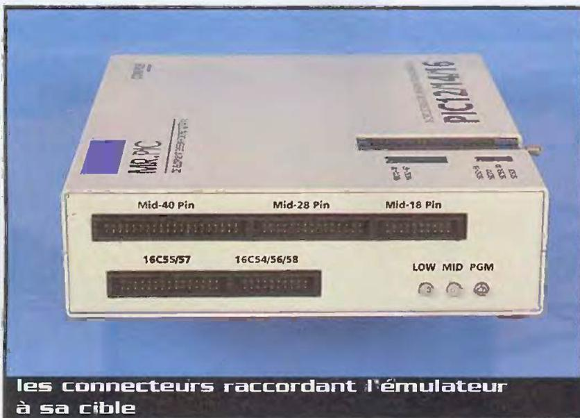
**les connecteurs raccordant l'émulateur à sa cible**
