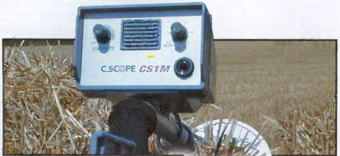
Si l'on excepte les appareils à usage résolument professionnel que sont, par exemple, les magnétomètres et les radars souterrains, quasiment tous les détecteurs de métaux font appel au même principe de base : la modification des caractéristiques électriques d'un bobinage lorsqu'un corps métallique en est approché.
