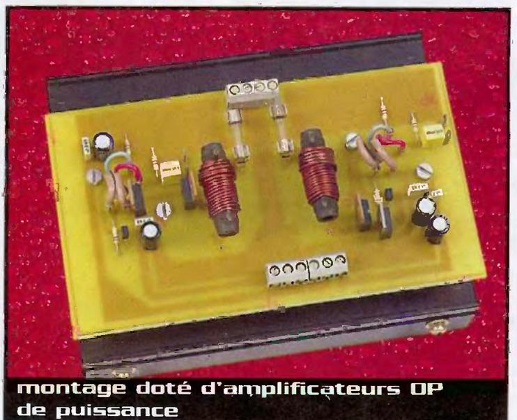
montage doté d'amplificateurs OP de puissance
