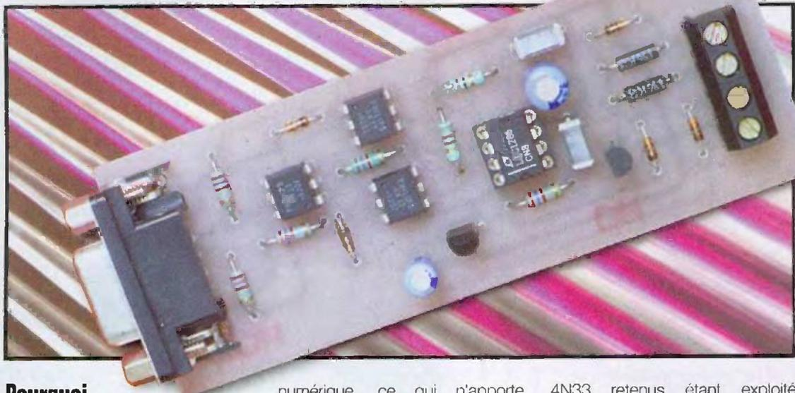
Il a déjà été publié beaucoup de schémas d'entrées analogiques pour PC, mais rares sont ceux qui bénéficient d'une isolation galvanique. Raccordé sur un port série très ordinaire, le présent montage sépare totalement la masse du PC (en principe reliée à la terre) de celle du circuit de mesure. Cela, en associant tout simplement quelques photo-coupleurs à un convertisseur analogique/numérique "série" 8 bits ou même 12 bits
