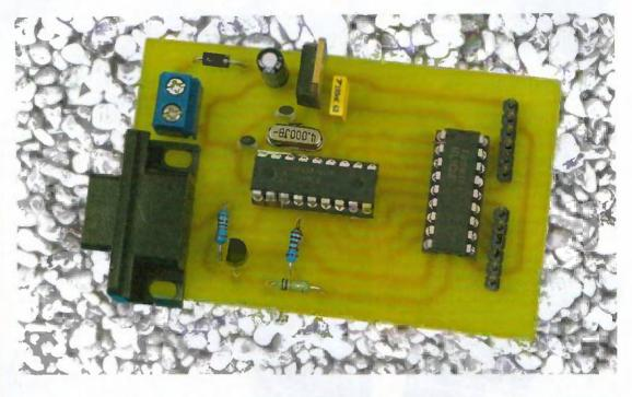
Le montage présenté ici permet la commande de deux moteurs pas à pas unipolaires par un PC. Les ordres sont envoyés par un des ports séries COM1 ou COM2 à l'alde d'un logiciel de communication
