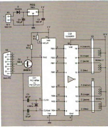
Schéma électrique de la commande de deux moteurs
