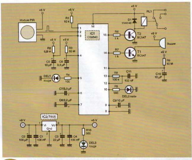
Schéma de principe de l'alarme
