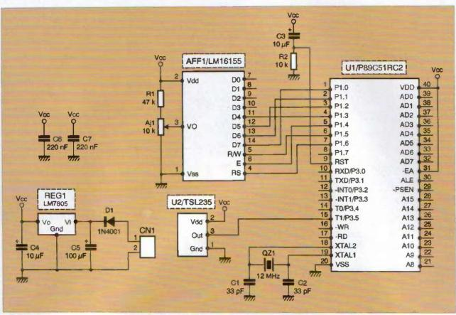
Schéma du mesureur d'intensité lumineuse avec capteur TSL235
