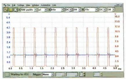
Contrôle du servo du papillon des gaz
