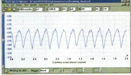
Contrôle des compressions d'un moteur diesel 4 cylindres
