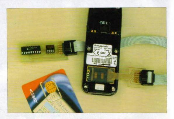
Au delà des applications peu avouables qui ont fait sa renommée, la "Gold Wafer card" se prête à une foule d'expérimentations en rapport avec les cartes à puces. Émuler une telle carte à partir de composants en boîtiers DIP et d'adaptateurs connectiques interchangeables, permet d'aller encore bien plus loin, notamment dans le domaine de la téléphonle mobile.
