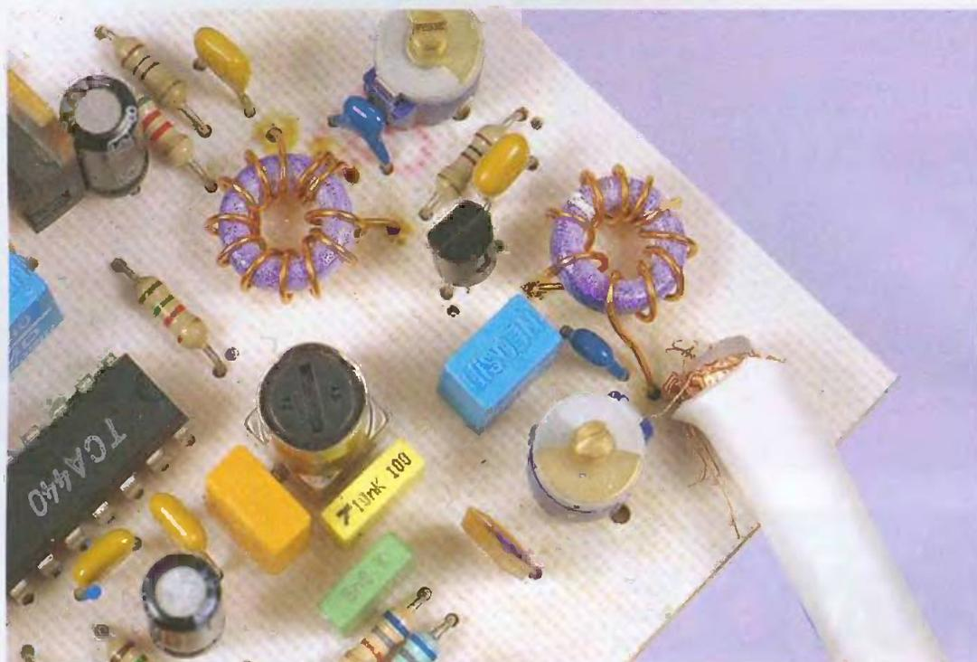
**Ce montage simple à réaliser et à régler est destiné à la découverte de l'activité de la bande des 20 mètres (14 MHz/14,35 MHz), dédiée principalement aux communications internationales entre radioamateurs.**
