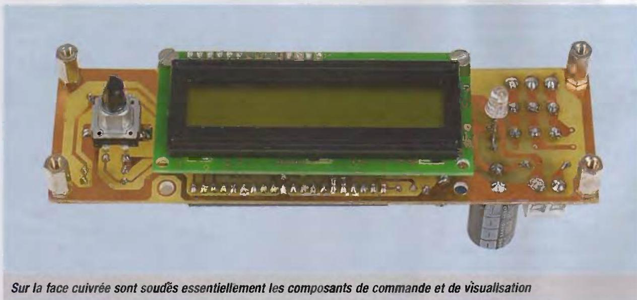
Sur la face cuivrée sont soudés essentiellement les composants de commande et de visualisation
