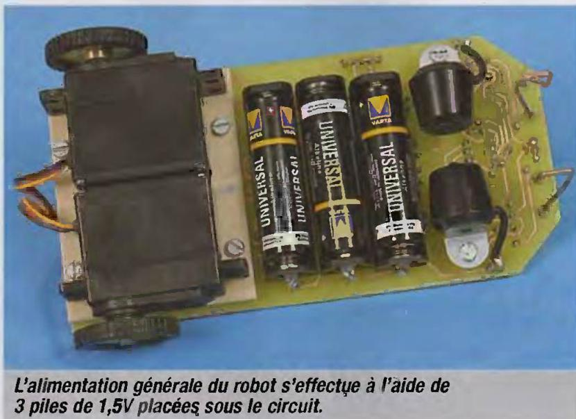
L'alimentation générale du robot s'effectue à l'aide de 3 piles de 1,5V placées sous le circuit.
