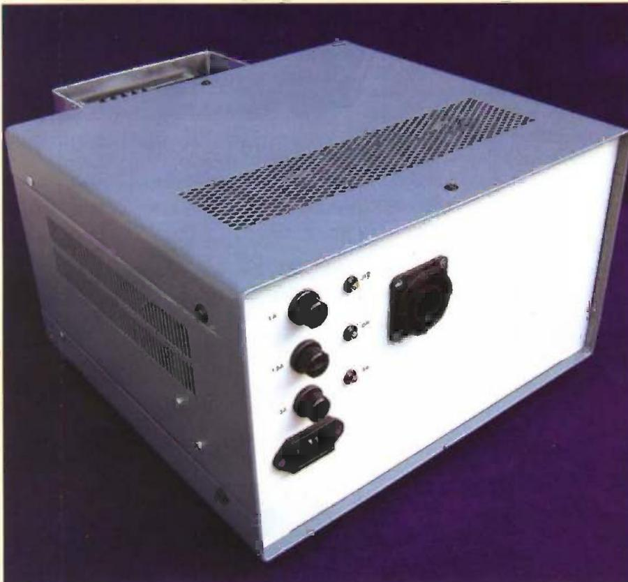
**Cette alimentation est le deuxième volet de notre étude de l'amplificateur Push-Pull ultra-linéaire de 5 x 24 Weff. Elle est conçue pour fournir une tension de 485 Vdc stabilisée sous un courant de 850 mA.**
